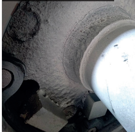
Fig 2: Criccata sulla sezione base del perno, a ridosso delle flange di calettamento sul mantello. Metodo di controllo: magnetoscopico a contrasto di colore.
